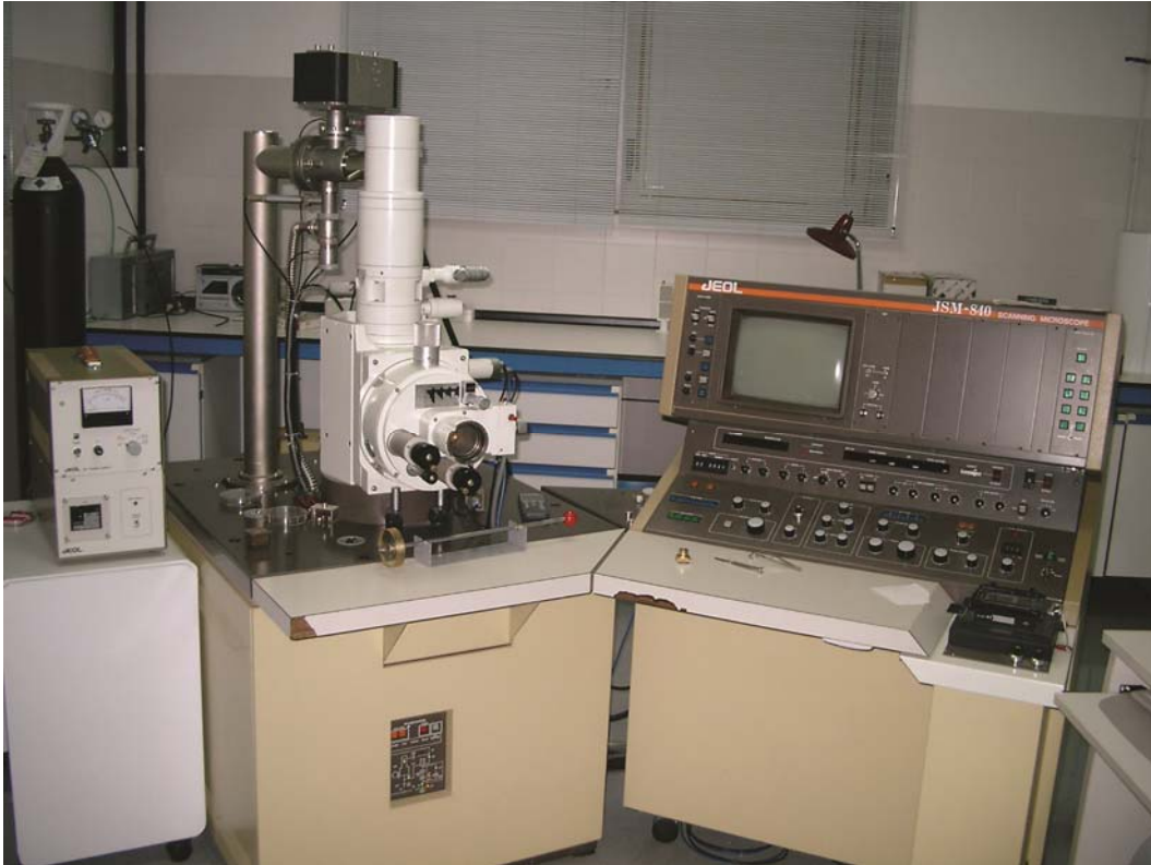
Figura 13. Imagen de un microscopio electrónico de barrido, herramienta habitual en los estudios palinológicos.
